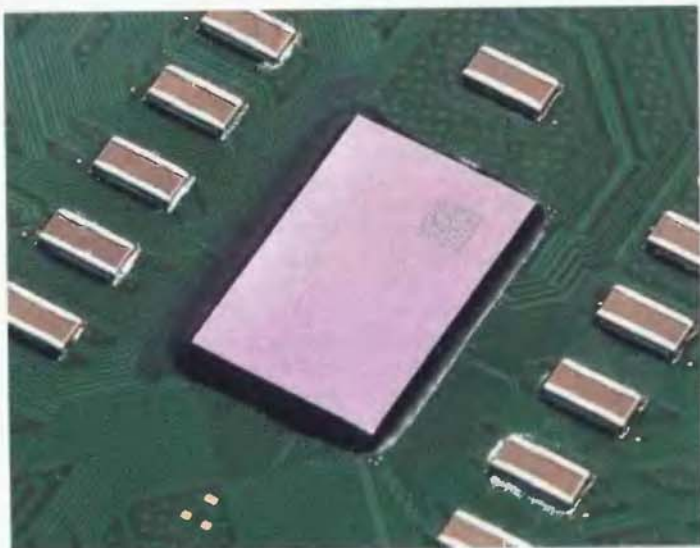
Упаковка FCPGA. Пока еще выпускать процессоры с "внешним" ядром возможно, однако очень скоро этот способ упаковки себя изживет.
