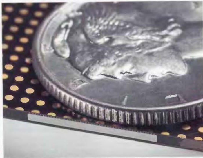
Упаковка BBUL. Само ядро интегрировано в подложку так, что нигде не выступает за ее пределы, что позволит снизить риск повреждения кристалла.
