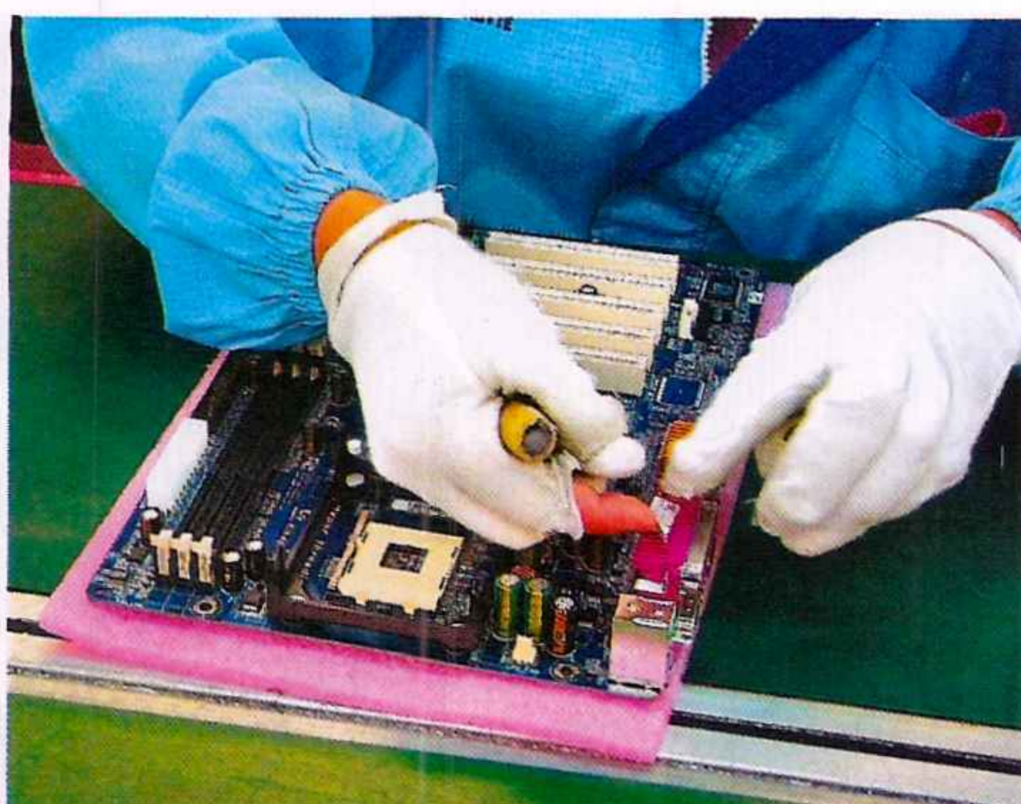
Один из немногих ручных этапов сборки платы - наклеивание стикеров. Мешкать нельзя - конвейер движется, и плата едет дальше, на упаковку.
