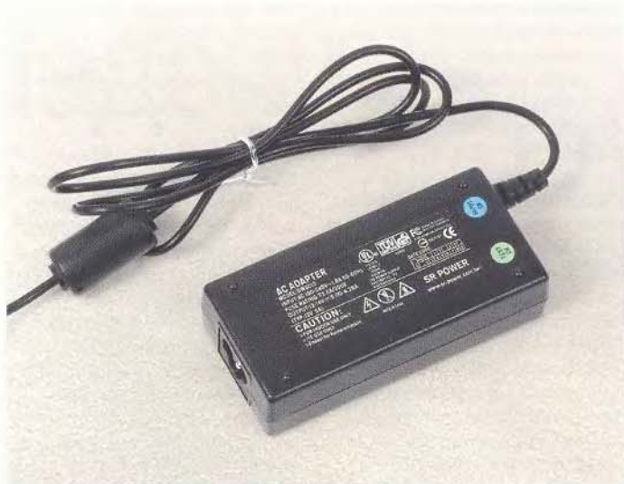
Внешний блок питания мощностью всего шестьдесят ватт. Довольно интересная концепция, надеемся, что она приживется в нормальных ПК.
