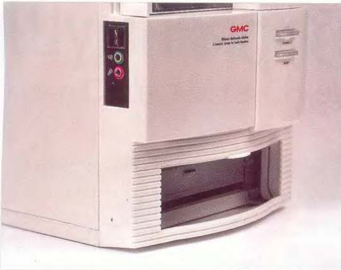
Под передней панелью корпуса есть дополнительный отсек 5,25", куда можно устанавливать дополнительное оборудование.
