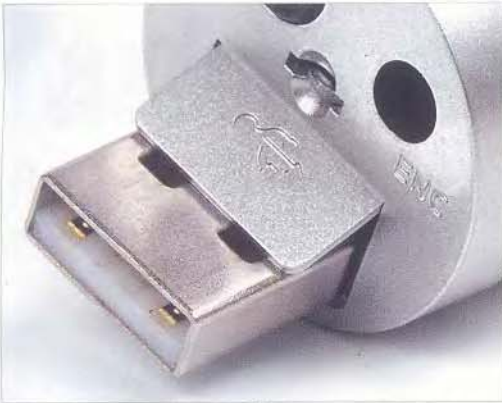
Выезжающее из недр корпуса USB-жало и заглушка, уходящая в корпус при подключении к порту.
