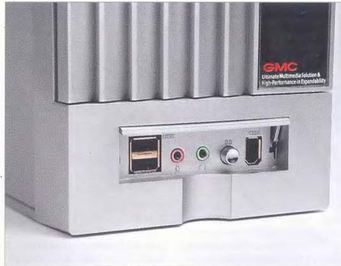
На переднюю панель вынесены: 2 порта USB, выходы для микрофона и наушников, кнопка отключения звука, а также один порт FireWire.
