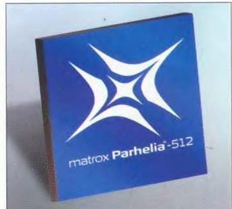
Еще одна функция HDM-движка – тесселяция по глубине. Не вдаваясь в подробности, опишем эту функцию как возможность чипа не заниматься расчетом безумного количества полигонов в тех местах сцены, которая "удалена от глаз пользователя", и обсчитывать полигоны по той же модели, по какой построен тире mapping для текстур – чем ближе объект, тем выше детализация и наоборот.
