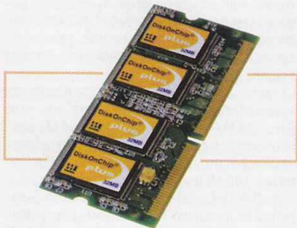
ство имеет 16-битную внутреннюю и внешнюю шины и создано с применением технологического процесса 0,16 микрон. Скорость чтения составляет 3 Мб/сек, запись в два раза медленнее – 1,5 Мб/сек. Инженерные сэмплы уже готовы, в продаже устройство появится совсем скоро.
