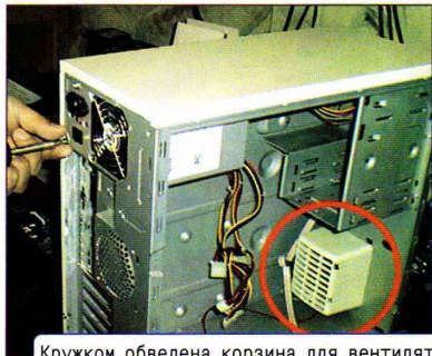
Кружком обведена корзина для вентилятора, которая при необходимости может крепиться и на заднюю стенку.
