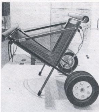
Тележка для перевозки досок для виндсерфинга. Разработчик — НИКОЛАС О'КОННЕР, окончивший школу Марка Ратерфорда в Бетфорде. Тележка выполнена из стальных трубок и установлена на широких обрезиненных колесах. Изделие обладает высокими потребительскими характеристиками, его удобно укладывать в багажник автомобиля. Проект отличается технологичностью при низкой стоимости производства
