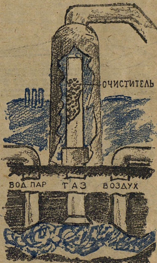
Схема газификации угля. Пар и воздух поднимаются под землю для сжигания угля, а водяной газ поступает по средней трубе в газохранилище
