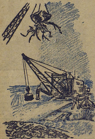
Струя воды размывает болото, торфосос поглощает гидромассу. Наверху кран, вытаскивающий пни и коряги из болота
