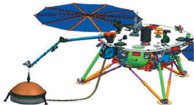
▲ Манипулятор сначала выставляет на поверхность сейсмометр, а затем закрывает его защитным колпаком
