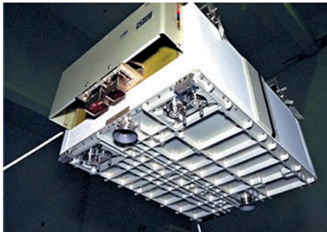
▼ Замена блока управления насосами PFCS – главная задача выхода EVA-50
