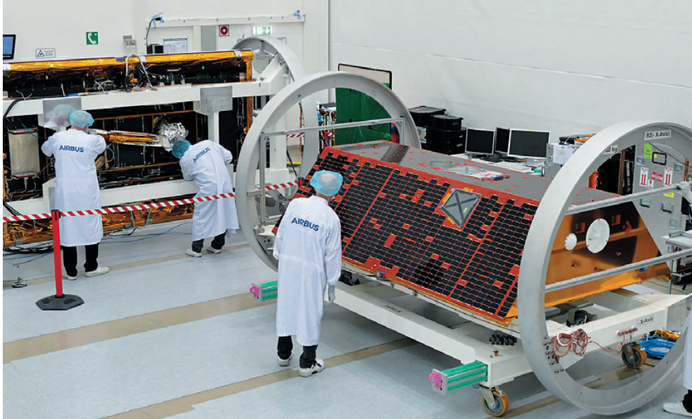
▲ Аппараты GRACE-FO на сборке в компании Airbus
