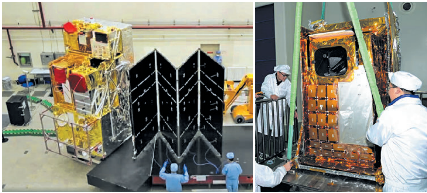
▲ Спутник «Гаофэнь-5» и мультиспектральная камера VIMI (справа)
