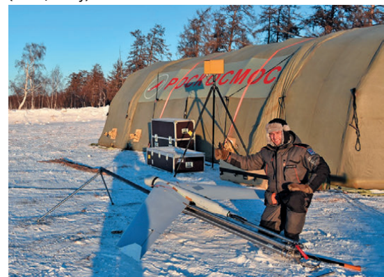
▲ Рис. 8. Применение технических средств контроля за падением ОЧ РН (РЛСК, вверху) и поиска мест падения фрагментов ОЧ РН (БПЛА, внизу) в РП 985
