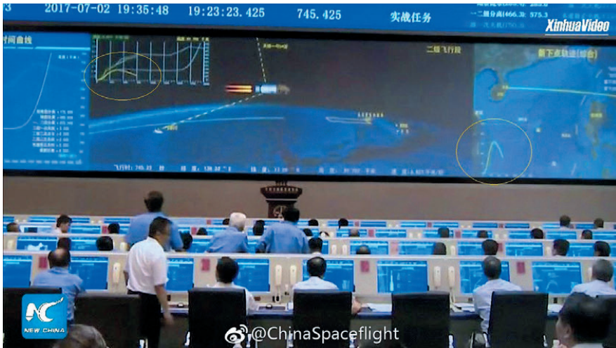
▲ Экран главного зала управления на 745-й секунде от старта. Анимация показывает работу ЖРД 2-й ступени. На выделенных участках графиков видно катастрофическое снижение высоты полета
