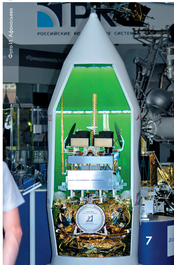
▼ Макет спутника «Арктика-М» с РБ «Фрегат» под обтекателем
