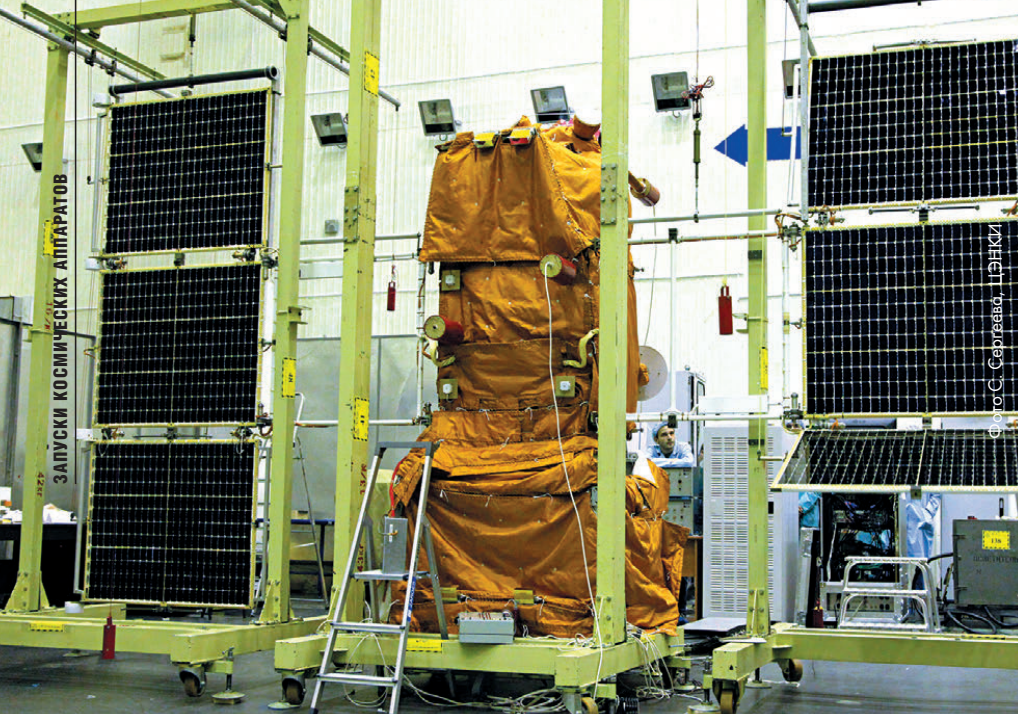
▲ «Канопус-В-ИК» во время испытаний солнечных батарей
