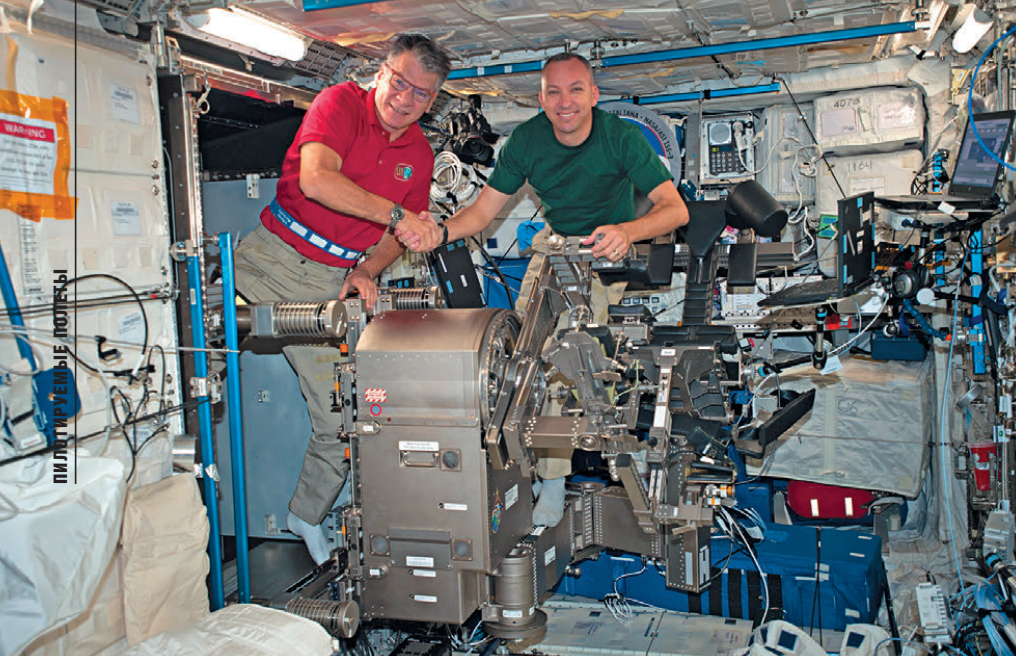
▲ Неспולי и Брезник готовят тренажер-динамометр MARES для эксперимента «Сарколаб»
