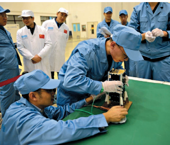
▼ Кубсат готовят к установке в контейнер
