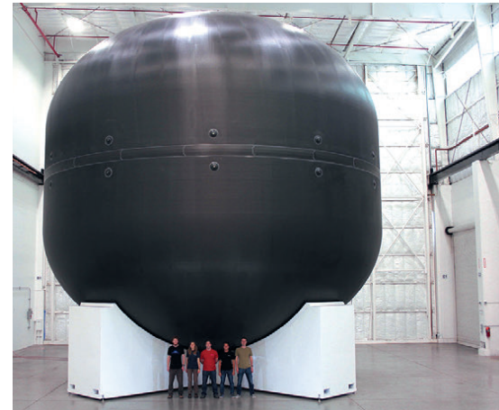
▲ Углеродистый бак диаметром 12 метров
