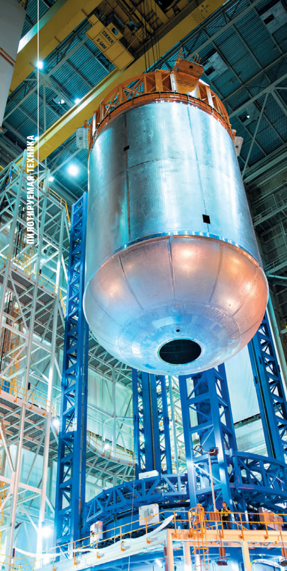
▲ Сварка бака жидкого кислорода носителя SLS
