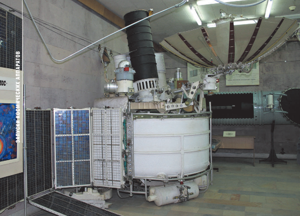
▲ Космический аппарат серии «Космос», выводимый на высокоэллиптическую орбиту, в музее НПО имени С.А.Лавочкина. Внизу – бленды оптической аппаратуры
