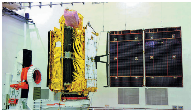
▲ Гео стационарный спутник GSAT-6 и 6-метровая развертываемая антенна S-диапазона
