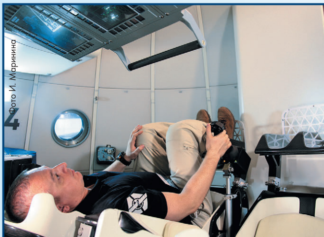
★ Космонавт-испытатель РКК «Энергия» Марк Серов продемонстрировал интерьер нового корабля, кресло «Чегет» и доступность нового пульта управления
