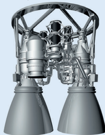
▲ Вариант ДУ PH Atlas V с ЖРД AR1
