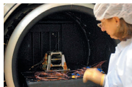
▲ Бразильский Nanosat BR1 в термобарокамере
