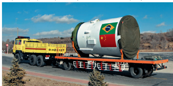
▼ Транспортировка третьей ступени РН CZ-4В на стартовую позицию
