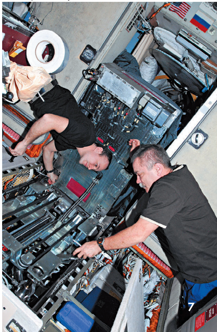
▼ Сергей и Михаил отключают систему виброизоляции под беговой дорожкой в модуле «Звезда»
