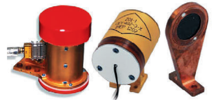
▲ Рентгеновский спектрометр APXS (излучатель, радиоизотопный источник тепла и контрольная мишень)
