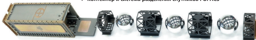
▼ Контейнер и система разделения спутников POPACS
