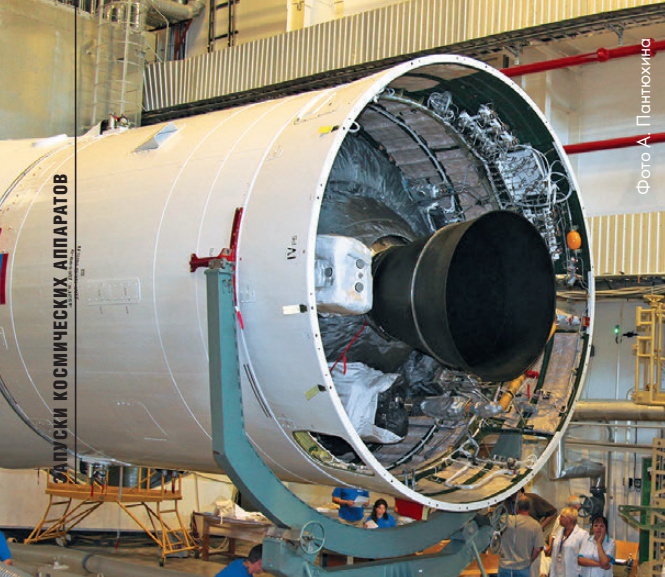
▲ Разгонный блок ДМ-SLB №6Л был заправлен высокоэнергетическим топливом синтин
