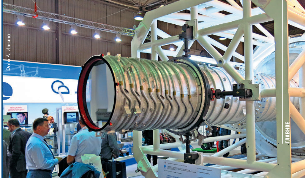
★ Оптико-электронная аппаратура ДЗЗ «Геотон-Л1» для КА «Ресурс-П»
