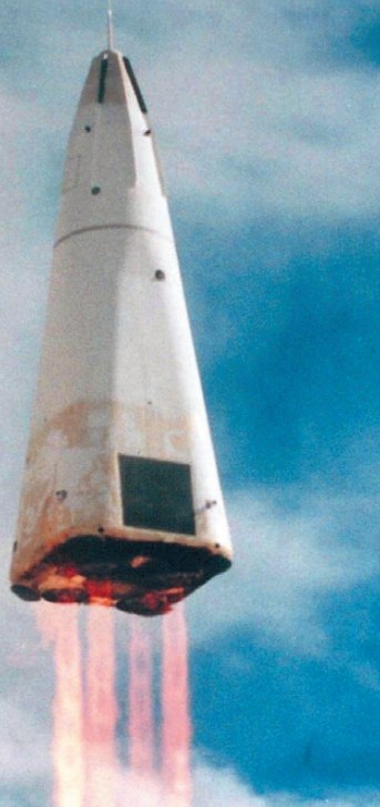
▲ Многоразовый одноступенчатый демонстратор DC-X в испытательном полете
