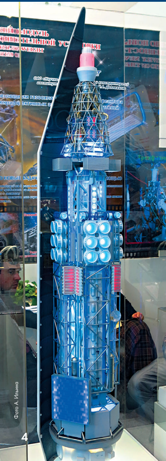
★ Макет транспортно-энергетического модуля с ЯЭДУ мегаваттного класса
