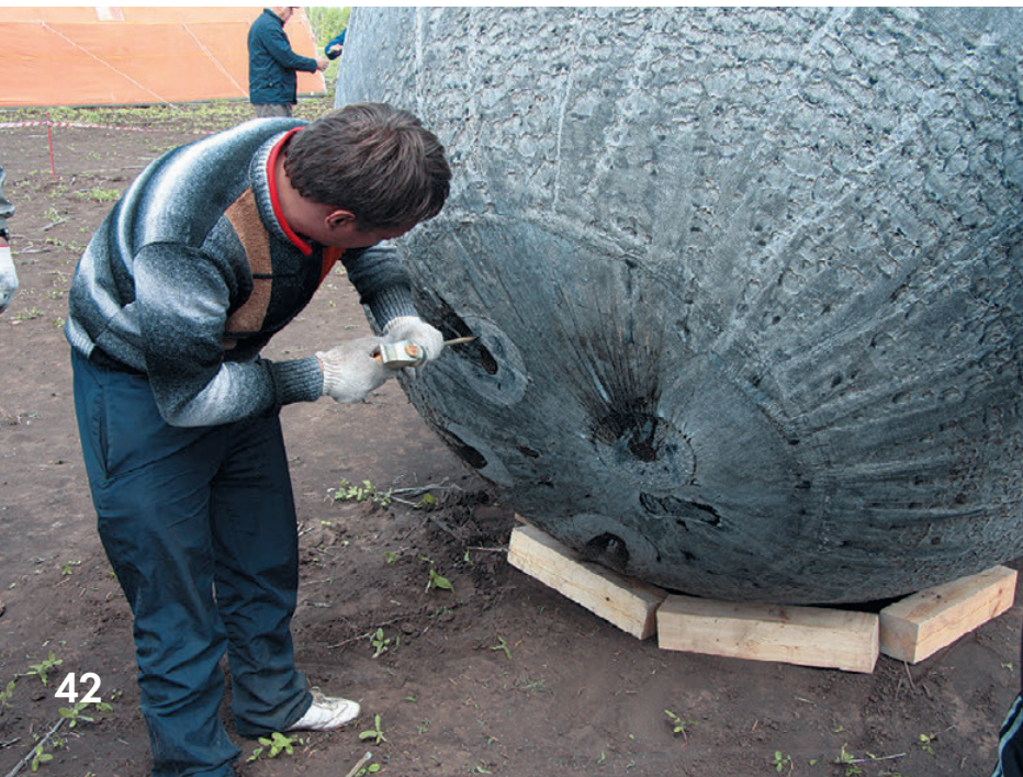
▼ Извлечение образцов «Метеорита» из дна спускаемого аппарата. Справа – открытие контейнера КНА-Б с экспонированными образцами
