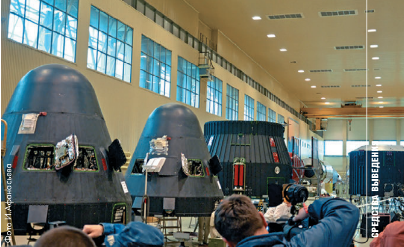
▲ Обтекатели боковых блоков и промежуточные отсеки «Ангары-А5»
