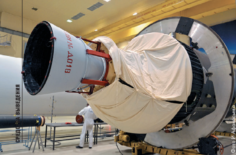
▲ Блоки второй летной «Ангары» готовятся к отправке. На переднем плане двигатель первой ступени РД-191
