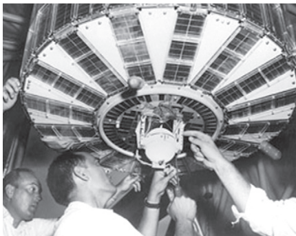
▲ Первым спутником с радиоизотопным генератором стал американский навигационный Transit-4A , запущенный 29 июня 1961 г. Плутониевый РИТЭГ SNAP-3B7 с электрической мощностью 2,7 Вт имел массу 2,1 кг и был размером с грейпфрут
