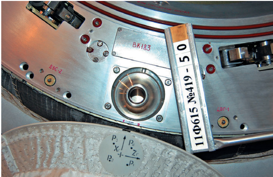
▲ Рис. 4. Положение чашки антенны 2АСФ1-М-ВКА №2 при подготовке «Прогресса М-19М» на Байконуре
