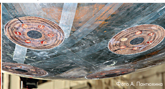
▼ Подготовка плат полезной нагрузки (ППН) и места их установки в контейнерах КНА-Б. В центре – образцы эксперимента «Метеорит» на теплозащите СА
