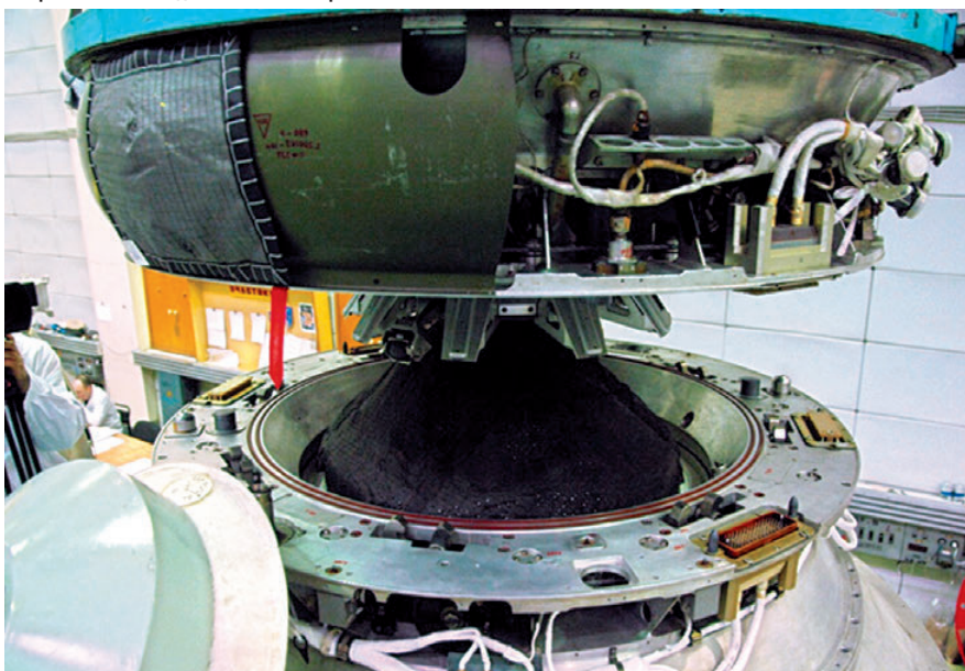
▼ Рис. 5. Отработка процесса стягивания «Прогресса М-19М» и МКС на физической модели в РКК «Энергия»
