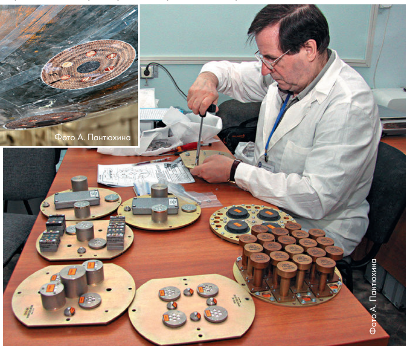
▼ Подготовка плат полезной нагрузки (ППН) и места их установки в контейнерах КНА-Б. В центре – образцы эксперимента «Метеорит» на теплозащите СА
