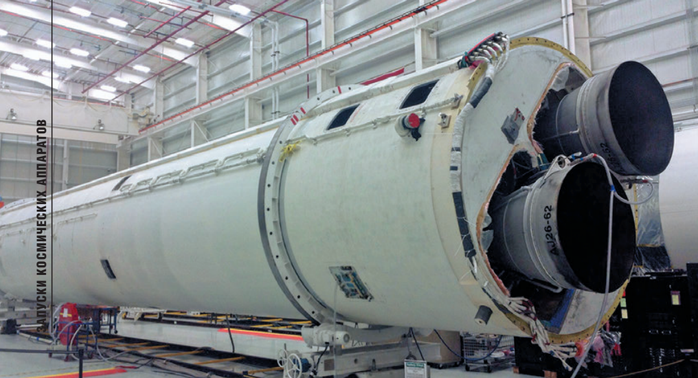
▲ Первая ступень PH Antares. Хорошо виден нагар на двигателях после огневых испытаний
