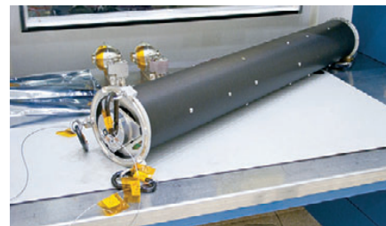
▼ Чувствительными элементами прибора EFWS являются сферические датчики на конце каждой из шести штанг
