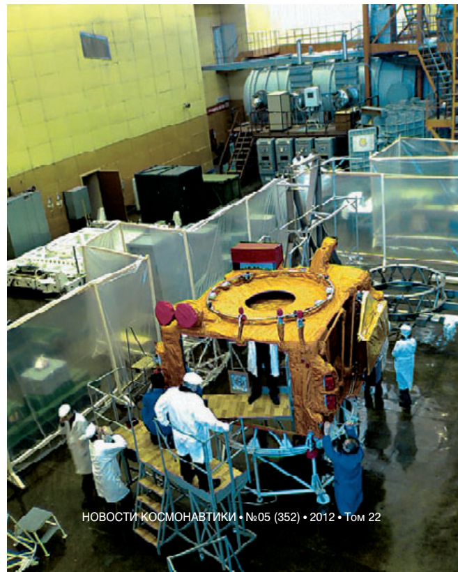
► Подготовка спутника «Экспресс-МД2» к испытаниям в тепловакуумной камере
