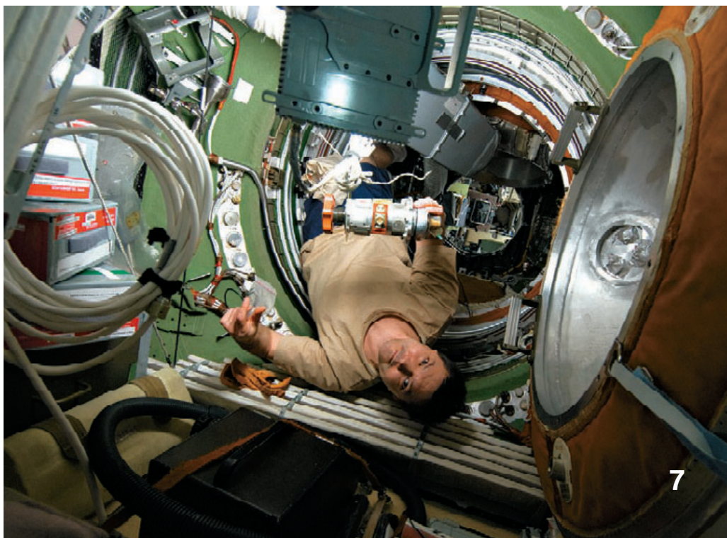
▼ Олег Кононенко меняет клапан выравнивания давления в переходном отсеке между ФГБ «Заря» и СМ «Звезда»
