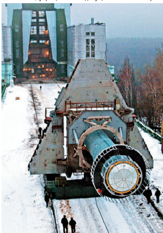
◀ Вывоз первой ступени РН «Союз-2.1В» на испытательный стенд
