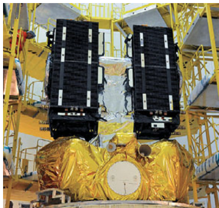
▲ «Фрегат-МТ» и спутники Galileo FM2 и PFM
