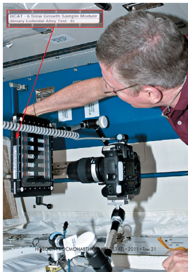
▼ Командир проводит съемку растущих кристаллов в эксперименте BCAT-6 (Binary Colloidal Alloy Test-6)
