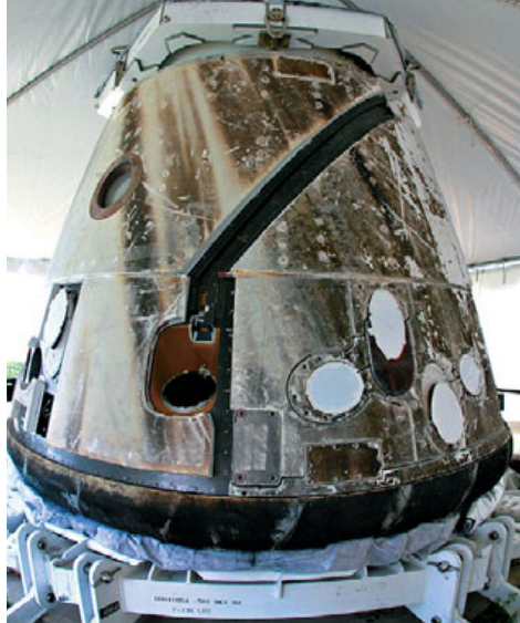
▲ Спускаемый аппарат корабля Dragon. Хорошо видно, как обгорела теплозащита при спуске в атмосфере Земли
