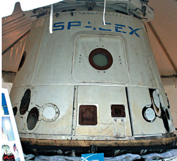
▲ Спускаемый аппарат корабля Dragon. Хорошо видно, как обгорела теплозащита при спуске в атмосфере Земли
