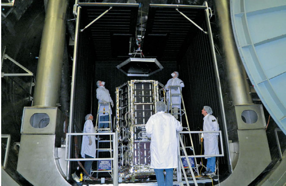
▲ Спутник ORS-1 на термовакуумных испытаниях
