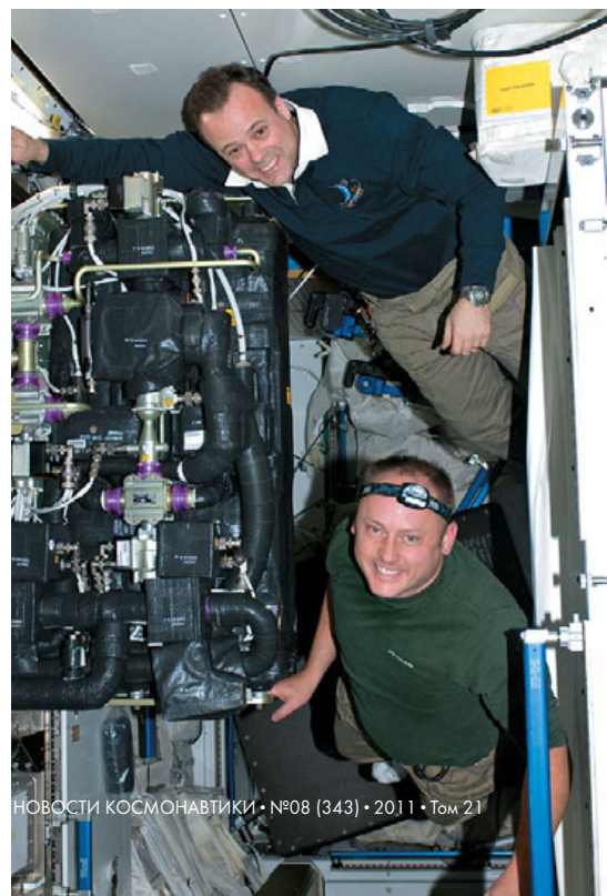
▼ Финк и Гаран ремонтируют установку для удаления CO 2 из атмосферы станции
