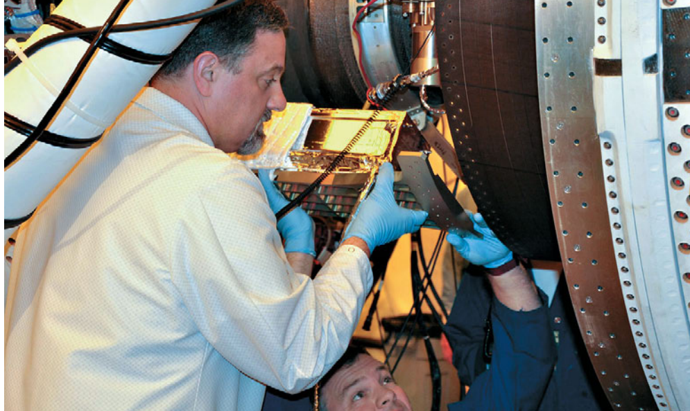
▲ Установка на третью ступень носителя контейнера P-POD с тремя наноспутниками
