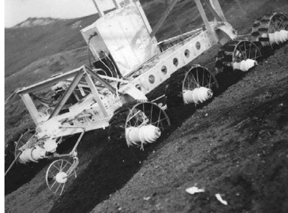
▲ Ходовой макет шасси «Лунохода» на испытаниях. Камчатка, район недавних извержений вулкана Шивелуч
