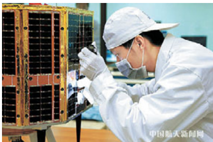
▲ Сборка радиолюбительского спутника «Сиван-1»
