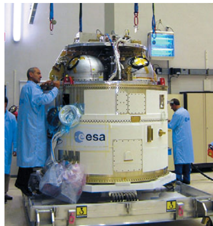
▲ Vega оснащена жидкостной ступенью довыведения AVUM, двигатель которой может до пяти раз включаться в космосе
