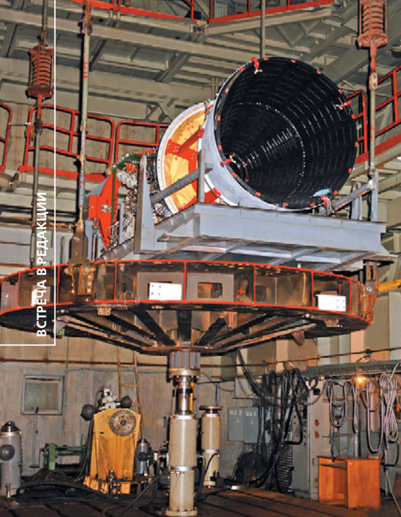
▲ Испытания двигателя РД-191 на электрогидравлическом вибростенде ЦНИИмаша. 2008 г.
