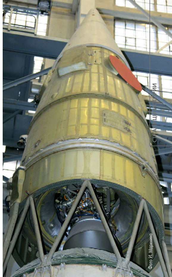
▲ Через ферменный межступенчатый переходник виден двигатель 8Д726 третьей (орбитальной) ступени ГР-1
