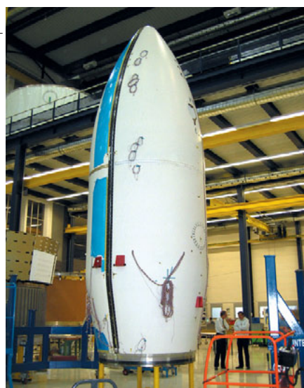
▲ Головной обтекатель со стандового образца «Веги» будет использован впоследствии при одном из первых пусков штатного носителя
