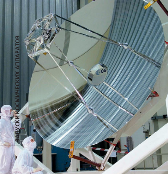
▲ Основное зеркало телескопа Herschel
