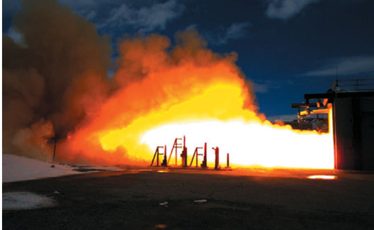
▲ 10 марта 2009 г. в на стенде компании ATK в штате Юта прошли испытания устройства зажигания РДТТ первой ступени PH Ares I
