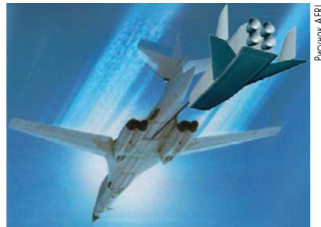
▲ Воздушный запуск ЛА, доставляемых на большую высоту за самолетами типа KC-10, B-1B или C-17
