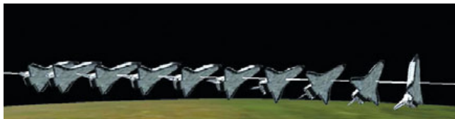
▲ Компьютерное моделирование полета «Колумбии» после утраты управляемости
