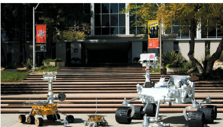
▼ Три поколения американских марсоходов: MER (2003), Sojourner (1996) и MSL (2011). Ровер MSL по размерам сравним с автомобилем
