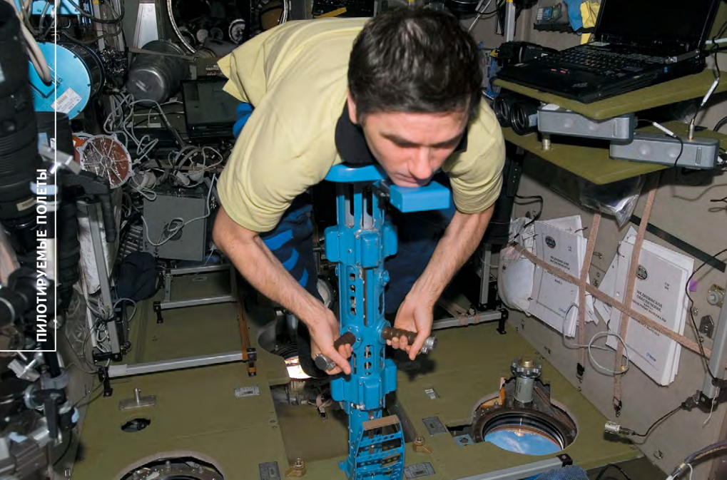
▲ Вот с помощью такого прибора в невесомости можно измерить массу тела
