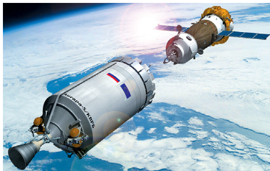
▲ Перспективный ПКК для выхода на окололунную орбиту. Показан в момент стыковки с кислородно-водородным разгонным блоком КВРБ на околоземной орбите
