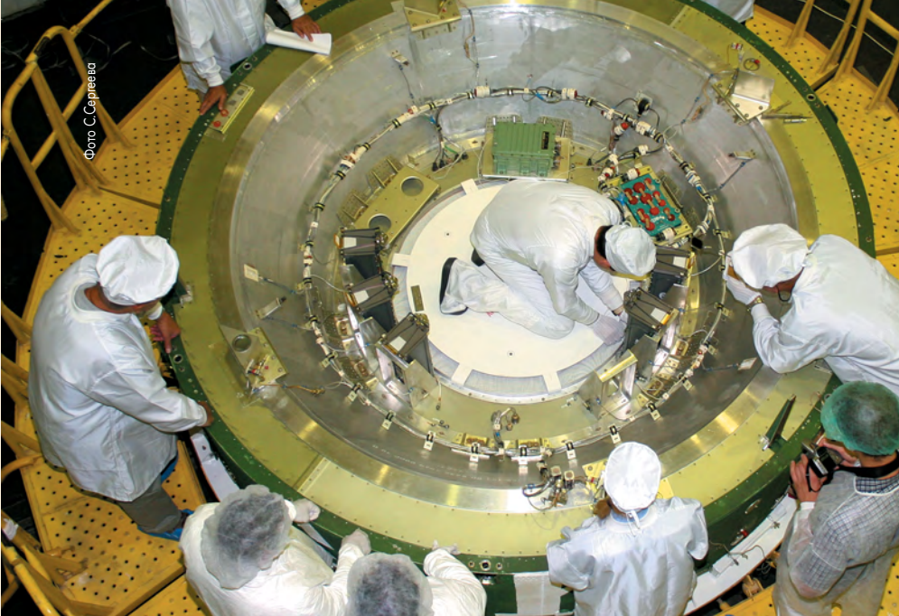
▲ Установка пяти контейнеров P-POD с 14-ю «Кубсатами» на адаптер «Днепра». МИК 31-й площадки, 15 июля 2006 г.
