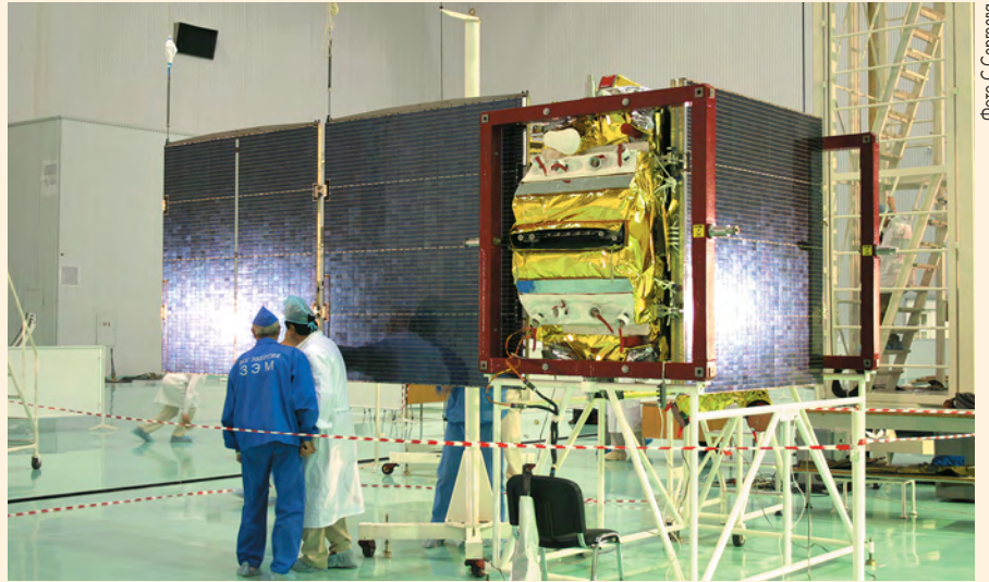
▲ Монтаж панелей солнечных батарей на КА «БелКА» в МИКе на 254 площадке. 9 июня 2006 г.
