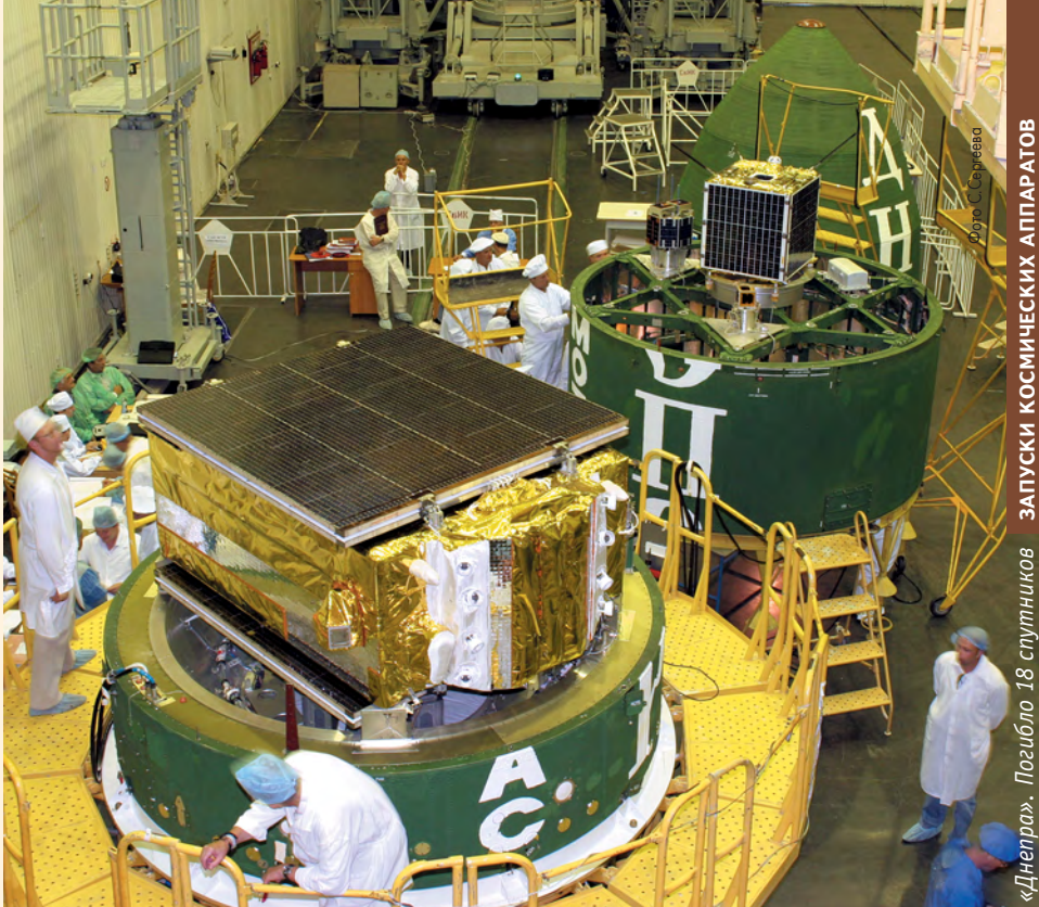
▲ Завершающий этап подготовки аппаратов – сборка головной части РН. Ближайший КА – «БелКА», под ним, на нижнем ярусе уже закреплены пять контейнеров с «кубсатами». На заднем плане – верхний ярус, здесь расположены «Бауманец», UniSat-4 (восьмигранник) и итальянский PICPOТ
