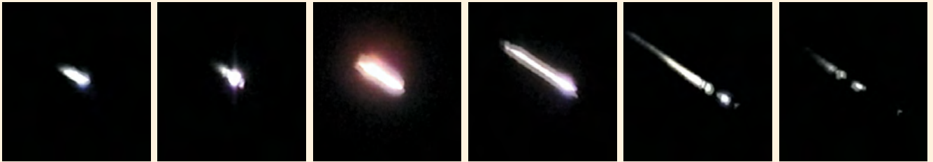
▲ Видеосъемка момента аварии РН «Днепр». На последних кадрах видно, как ракета разваливается на части
