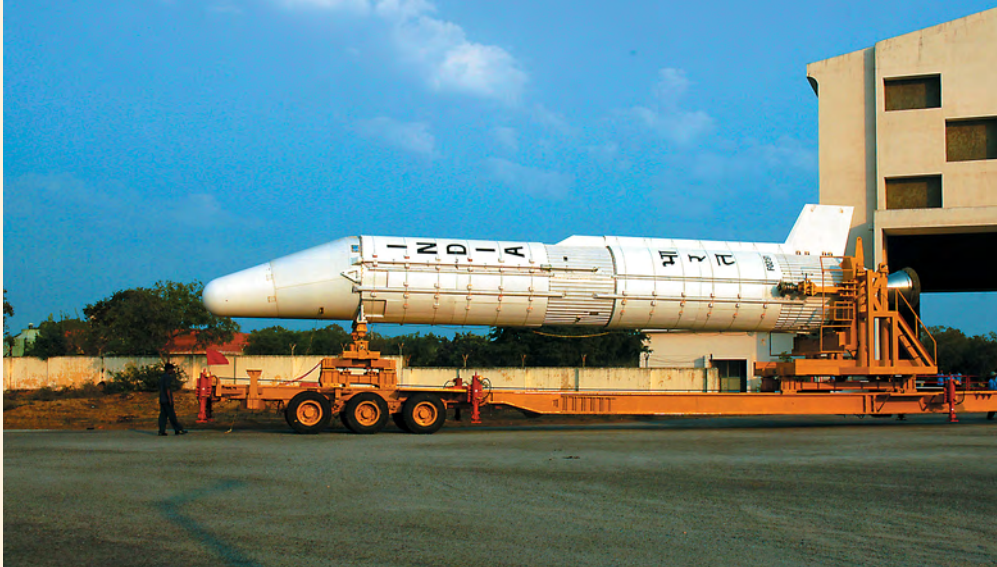
▲ Один из стартовых жидкостных ускорителей, отказ которого привел к аварии GSLV F02
