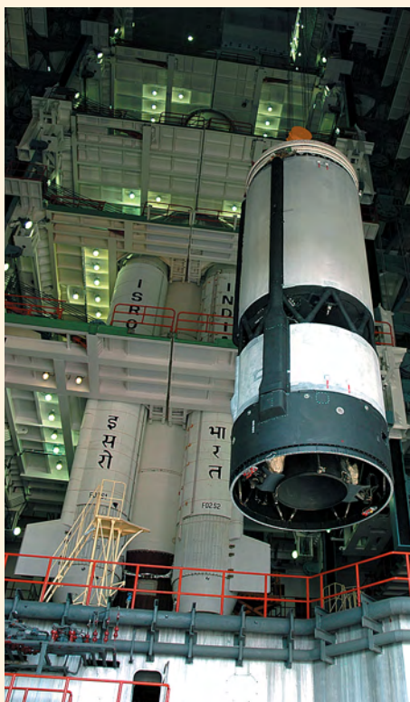
▲ Монтаж криогенной третьей ступени (блок 12КРБ №5)
