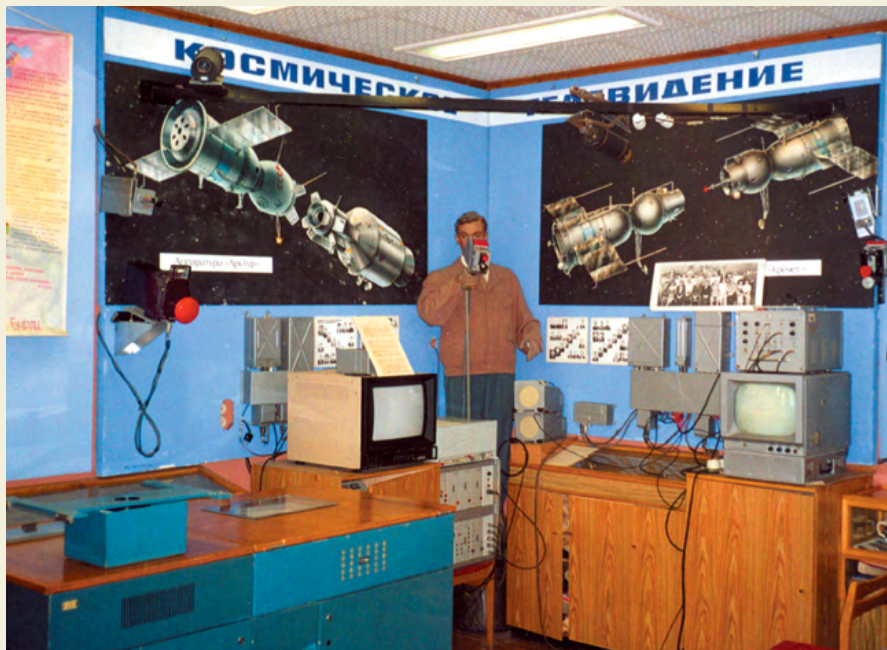
▲ Фрагмент экспозиции Музея ТВ ФГУП «НИИТ», посвященный первому международному полету КК «Союза-19» и «Аполлон» в июле 1975 года. Слева АР-201 — устройство преобразования сигналов цветного телевидения, над ним — телевизионная черно-белая камера «Кречет» КР-75А с камерным блоком КР-713А2, бортовая (верхняя камера) и репортажная камера АР-71ЦТ последовательной системы «Арктур» (с красной заглушкой на объективе); под рукой манекена индикаторы КР-73, предназначенные для визуального наблюдения на экране кинескопа изображения в двух режимах: телевизионного видеоконтрольного устройства и измерения параметров нерастровым методом для яркостных отметок, показывающих на шкале обрешетки данные работы различных систем. Справа сверху бортовая черно-белая камера «Кречет» КР-75А с камерным блоком КР-713А2, ниже репортажная черно-белая камера «Кречет» АР-71
