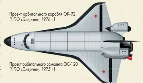
▲ Сравнение плановых проекций ОС-120 и ОК-92
