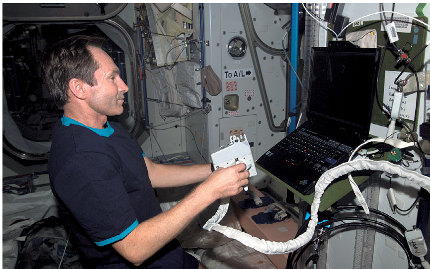
▲ Бортинженер тренируется управлять SAFER'ом на компьютерном имитаторе
