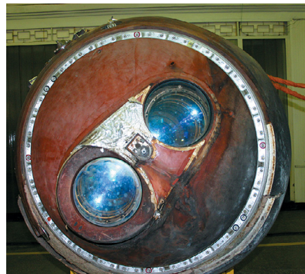
▲ СА фоторазведчика «Облик», его треснувшая теплозащита и объективы фотокамер
