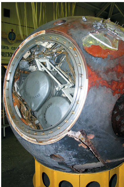
▲ СА фоторазведчика «Облик», его треснувшая теплозащита и объективы фотокамер
