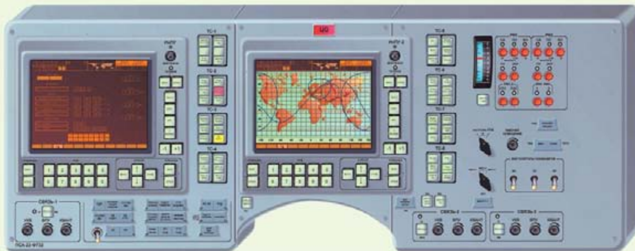
Пульт корабля «Союз ТМА» «Нептун-МЭ». Слева – представление текущей навигационной и дежурной баллистической информации корабля на люминесцентном экране (режим VGA, 9 цветов, диагональ 10.4”)
