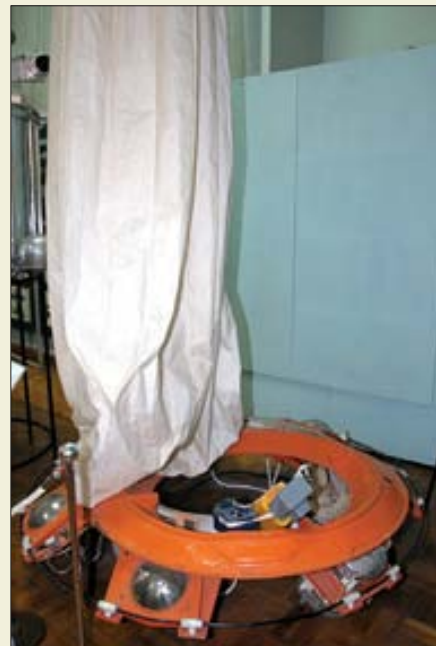
Торовый контейнер аэростатного зонда
