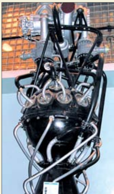
RD-110 представлял собой по существу масштабно увеличенный двигатель ракеты «Фау-2»: он имел большие габариты и сложную конструкцию
