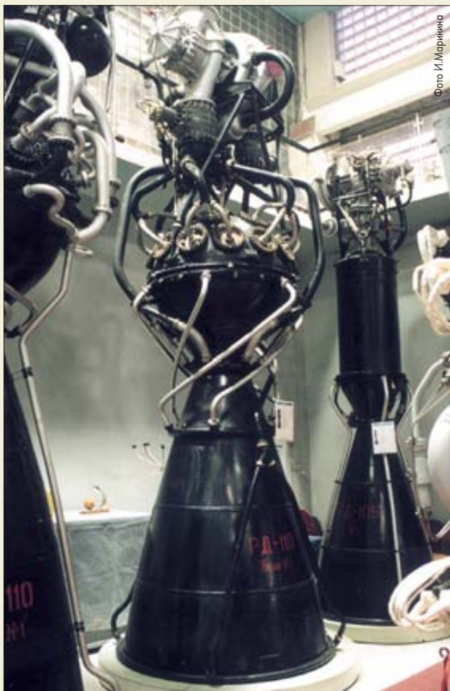
Камеры сгорания двигателей РД-110 и РД-105. Оба проекта реализованы не были
