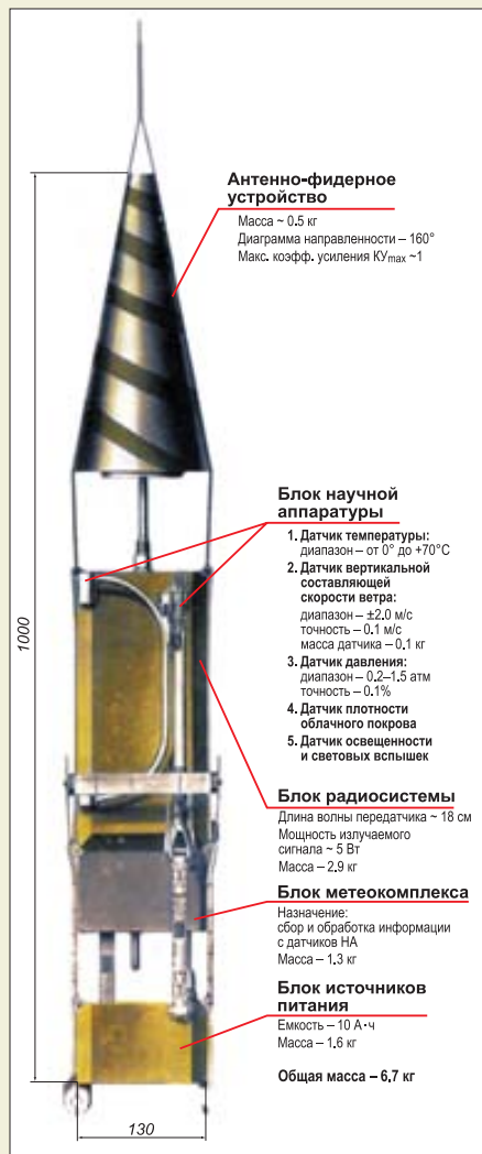
Конструкция гондолы аэростатного зонда
