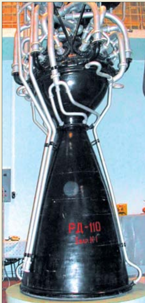
RD-110 представлял собой по существу масштабно увеличенный двигатель ракеты «Фау-2»: он имел большие габариты и сложную конструкцию
