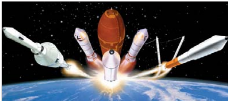
Некоторые варианты перспективных носителей для программы Буша основываются на технологиях Space Shuttle: Слева РН для корабля CEV на базе твердотопливного ускорителя, в центре – Shuttle-C, справа – сверхтяжелый носитель на базе центрального бака шаттла (около 100 т на низкую орбиту)
