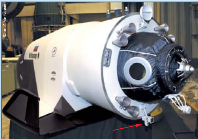
Модель крылатого варианта (1:5). Стрелкой показана телекамера контроля сближения и стыковки со станцией
