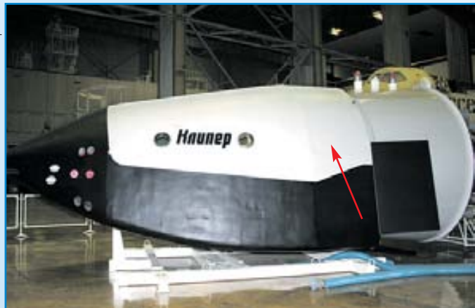
Полноразмерный макет «Клипера». Слева стрелкой показан посадочный люк для экипажа, справа – внутренний вид кабины
