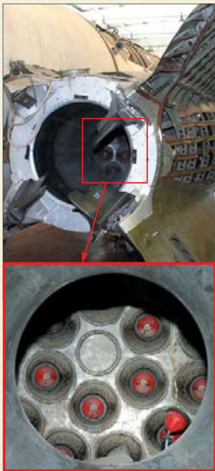
Вид на форкамеры двигателя РД-101 ракеты Р-2
