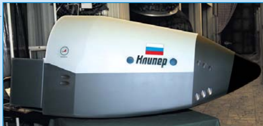
Модель ВА по схеме «несущий корпус» (1:5). ДПО на ВА расположены в принятой сейчас конфигурации
