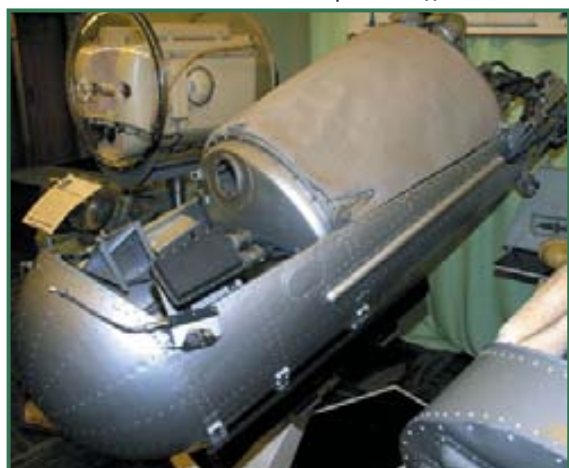
Герметичная кабина животного (ГКЖ-2) в катапультном кресле кораблей типа «Восток»
