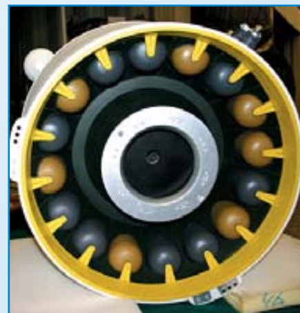
Модель агрегатного отсека «крылатого» варианта: вид на топливные баки внутри АО
