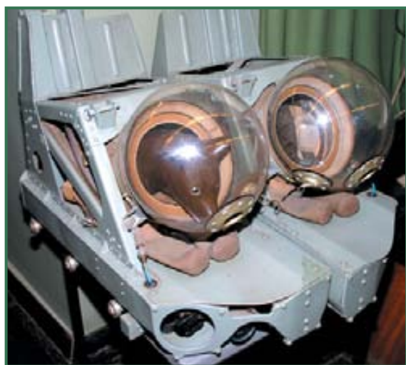
Катапультные тележки со скафандрами для собак использовались для полетов на высотных ракетах Р-1Д
