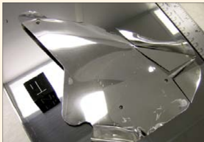
Фрагмент алюминиевой коллекторной пластины, распиленный на пять частей для дальнейших исследований
