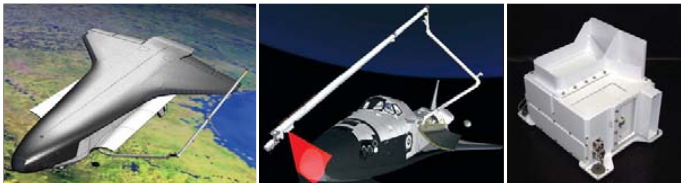
Штанга OBSS для контроля состояния теплозащиты шаттла и лазерная сканирующая 3D-камера компании Newport
