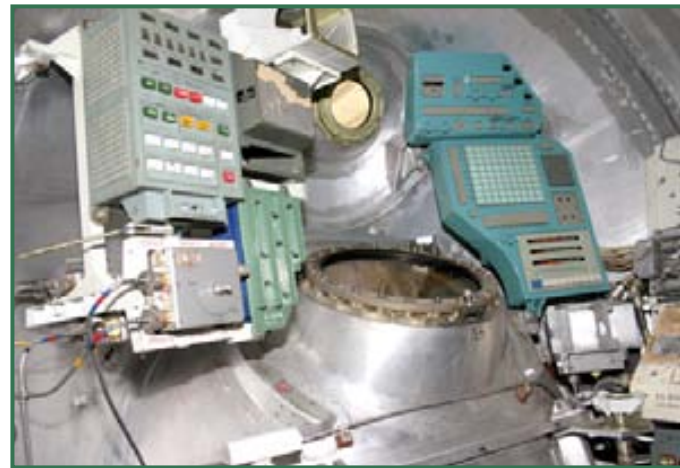
Кабина АК. Вид на пульты управления, посадочный и стыковочный иллюминаторы
