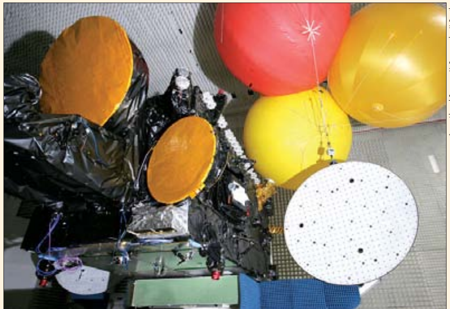
Испытания КА APStar 6 в беззюхой камере. «Воздушные шары» – система обезвешивания антенн
