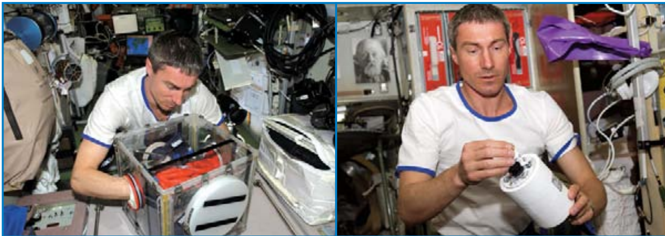
Сергей выполняет работы по российской научной программе. Слева – эксперимент «Межклеточное взаимодействие» в перчаточном боксе, справа – эксперимент СРСF-2 по получению кристаллов протеинов
