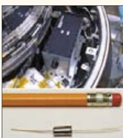
Датчик ускорения – вероятный «виновник» аварии капсулы «Генезиса»
