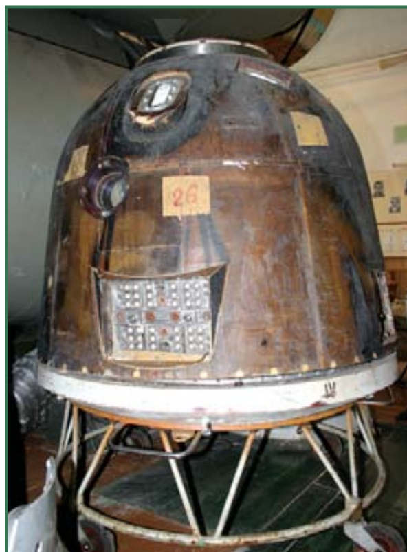
Спускаемый аппарат «Зонд-7» (11Ф91) №11, побывавший в космосе
