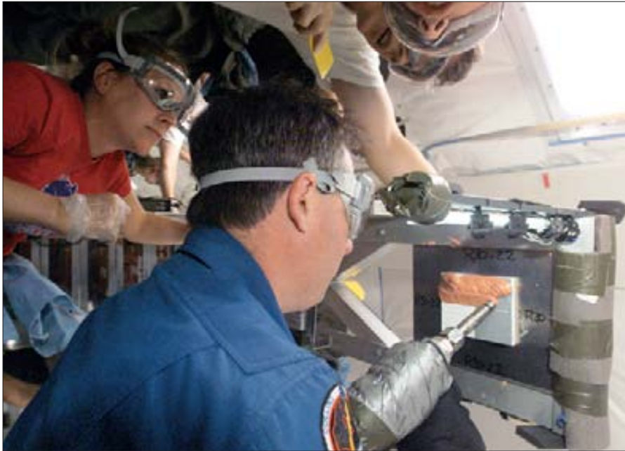
Астронавт Стивен Робинсон испытывает устройство СІРАА для ремонта плиток теплозащиты в условиях невесомости на борту летающей лаборатории КС-135
