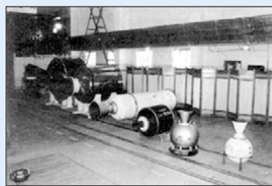
Китайские РДТТ (слева направо) – ЕРКМ, РКМ, FG-02, РКМ-77, FG-23, FG-47
