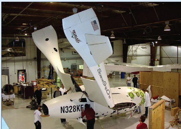
Демонстрация перевода крыла SpaceShipOne в положение на торможение
