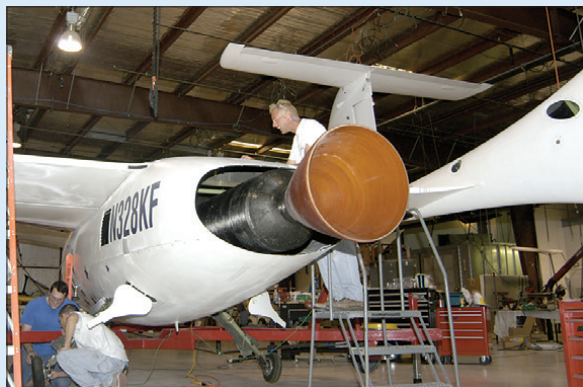
Установка ГРД компании SpaceDev на ракетоплан
