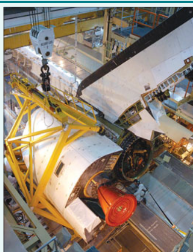
Установка левого блока системы орбитального маневрирования OMS на корабль «Дискавери» 21 апреля 2004 г.
