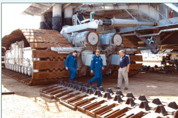
Члены экипажа STS-114 Джеймс Келли и Эндрю Томас и инженер NASA Роберт Рокбауэр осматривают траки мобильного транспортера, используемого для вывоза шаттла на старт. Каждый из 278 траков весит 1000 кг.
