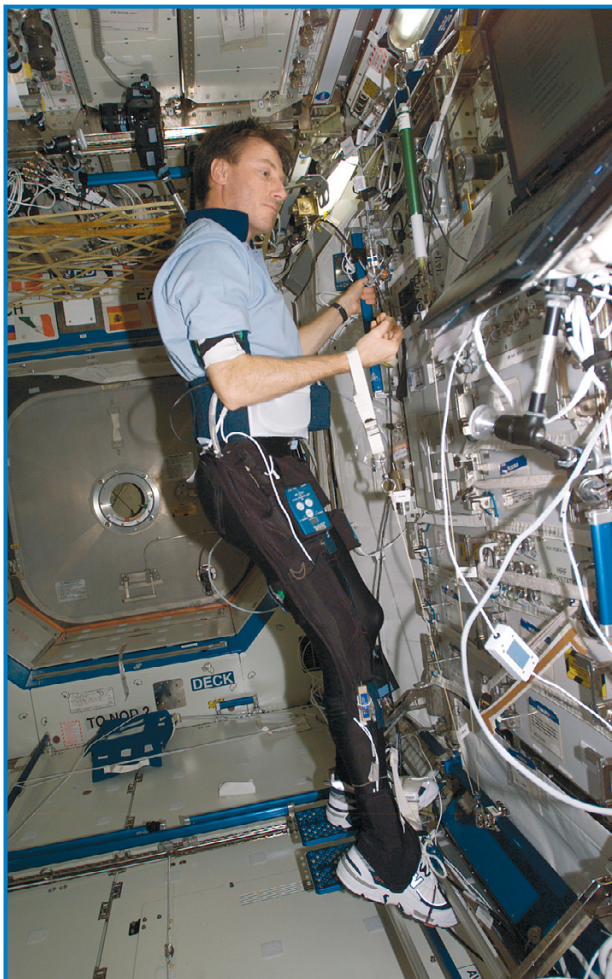
Майкл Фоул проводит эксперимент FOOT. На ногах у него – измерительная система LEMS с 20 датчиками, измеряющими усилия и мышечную активность
