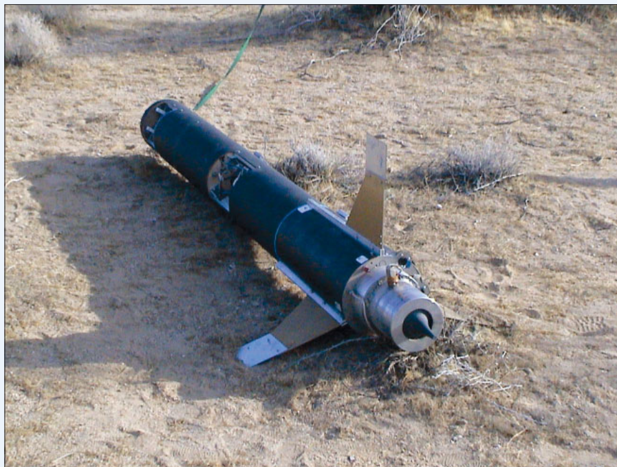
Prospector 4 с двигателем «аэроспайк» после возвращения из полета
