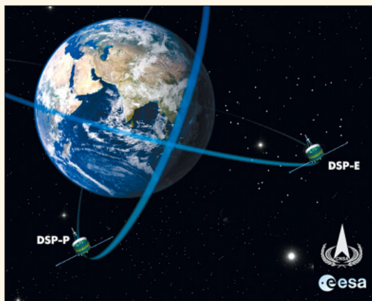
Система Double Star будет состоять из полярного и экваториального спутников
