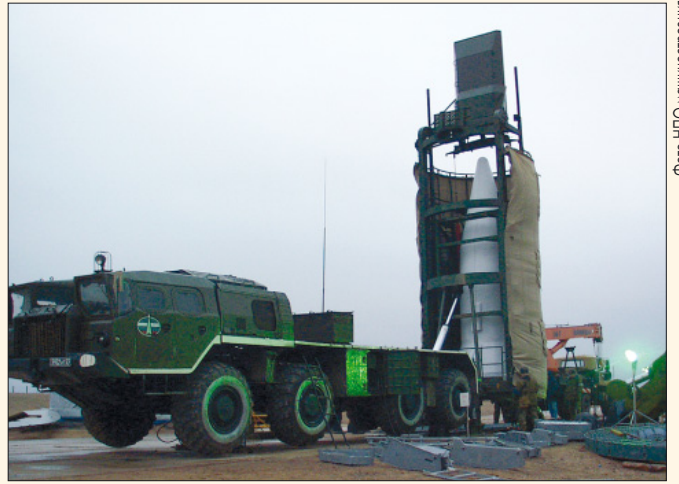
Установка КГЧ «Стрела» в ШПУ
