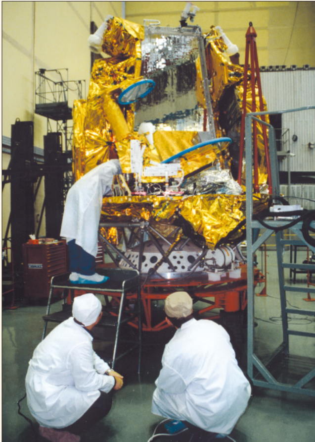
Подготовка модуля полезной нагрузки к монтажу в НПО ПМ специалистами Alcatel
